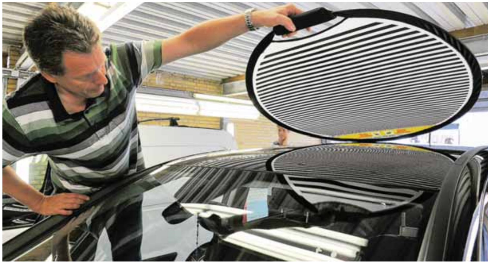
In einer gut ausgeleuchteten Halle in Augsburg prüft ein Gutachter das Dach eines Wagens auf Hagelschäden. Dazu nimmt er einen Reflektor zu Hilfe. Die Streifen spiegeln sich im Lack des Autos. Dellen verzerren die Reflexion und sind so besser zu erkennen. Foto: Fred Schöllhorn
